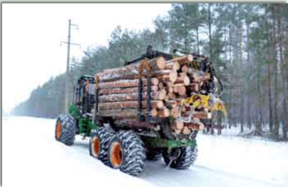
Подвозка древесины на промсклад организована с использованием форвардера, дальше везет сортиментовоз
